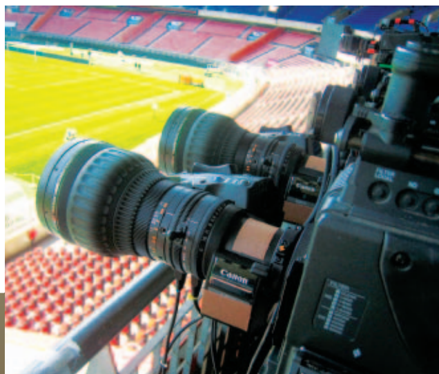
Пара объективов с Digital Drive, управляемых с помощью одного контроллера
